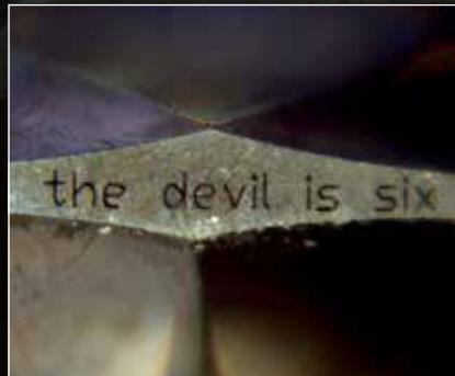
Auf der Rundiste wird die Vorlage mikroskopisch klein aufgelasert ohne den Stein zu beschädigen.
