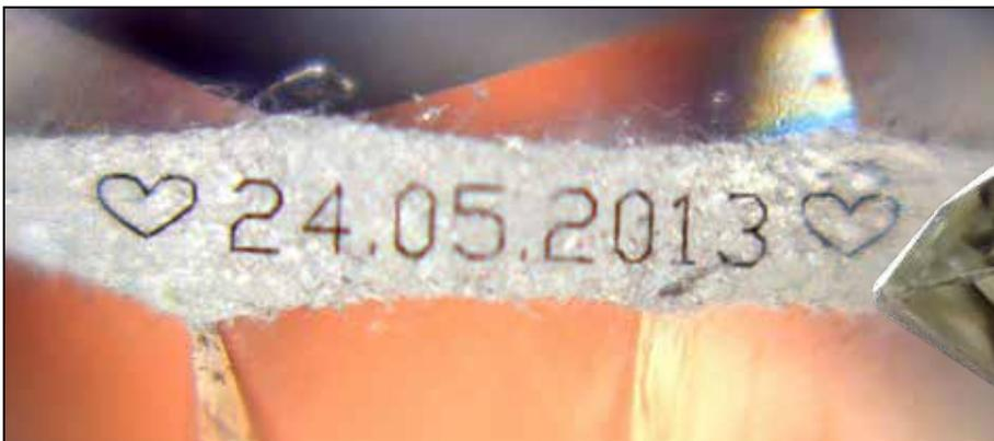
Mit größter Präzision lassen sich Schriften, Seriennummern oder einfache Logos auf die Rundseite von Diamanten gravieren. Mit dem bloßen Auge ist die Gravur nicht mehr zu erkennen. So wird jeder Stein zum unverwechselbaren Unikat.
